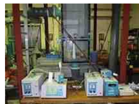
フィルタ捕集効率試験
