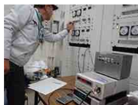
放射線計測システム点検校正
